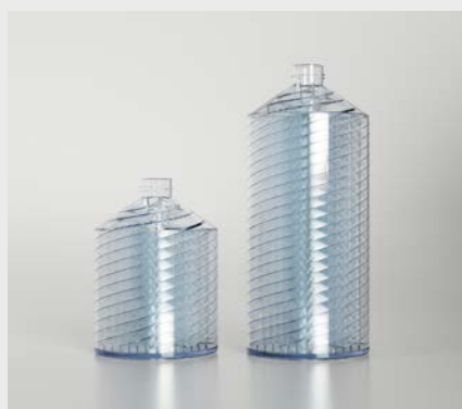
Die CellScrew CS10K (rechts) bietet mehr Wachstumsoberfläche als 125 Petrischalen.
